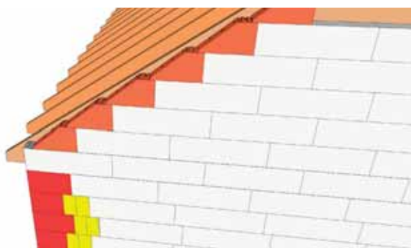
Blocs de rive posés en «escalier» suivant la pente de la toiture : 30 à 50°
